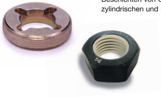
precote 4 ist eine nichtreaktive, filmbildende Dispersion mit mineralischen Feststoffen zum Beschichten von Gewindeteilen. Es ist eine Vorbeschichtung zum sofortigen Abdichten von zylindrischen und konischen Gewinden. Der aufgetrocknete Film ist griffest.
