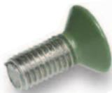
Die GESI-Seal Unterkopf-Dichtbeschichtung besteht aus einem thermoplastischen Beschichtungspulver, welches speziell für den Korrosionsschutz entwickelt wurde. Das Pulver wird direkt auf die Oberfläche des jeweiligen Bauteils bei ca. 210°C aufgeschmolzen.
