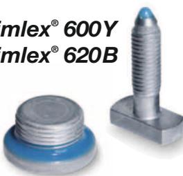
precote 200, Rimlex 600Y und Rimlex 620B sind hochelastische gut haftende und nicht zu harte Unterkopf-Flanschbeschichtung von Schrauben oder Dichtstopfen. So werden an diesen Stellen Abdichtungen zwischen den Anlageflächen erreicht. Die Dichteigenschaften werden sofort nach der Montage erreicht.
